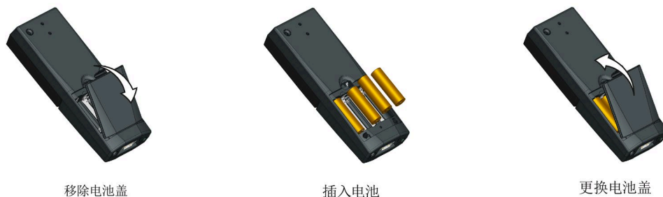
图 9-4 安装手持套件的电池
